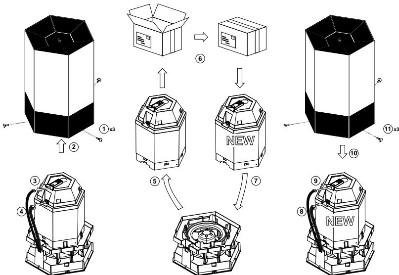
1. Enlever les 3 vis dans le sens inverse des aiguilles d'une montre.
